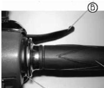
Нажмите на **ПРАВЫЙ** (по ходу движения мопеда) рычаг тормоза, до ощутимого сопротивления (0.3-0.5 кгс на конце рычага) на 5-7 сек. Измерьте пройденное концом рычага (обозначенным
